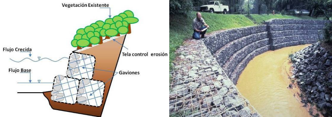
Figura 62: Protección con gaviones, esquema no a escala y fotografía.
