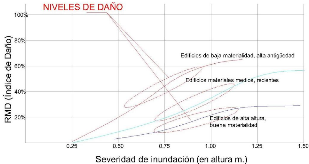
Figura N° 76. Funciones de vulnerabilidad a inundación para distintos casos de edificaciones. Fuente: PREDES y LPT-UCT 2014.
